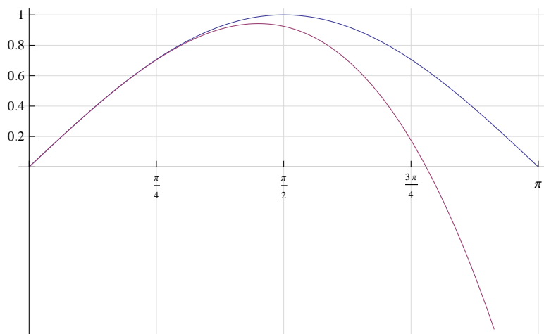
Figure 3: Jämförelse mellan \sin x (blått) och dess tredjegradsens Taylorpolynom (rött). Notera att i vår punkt \pi/2 så ligger kurvorna en bit från varandra. Det är detta som är felet.
